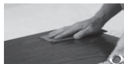
PONÇAGE À L'AIDE DE PAPIER ABRASIF DE CALIBRE 120-150 DANS LE SENS DU GRAIN
